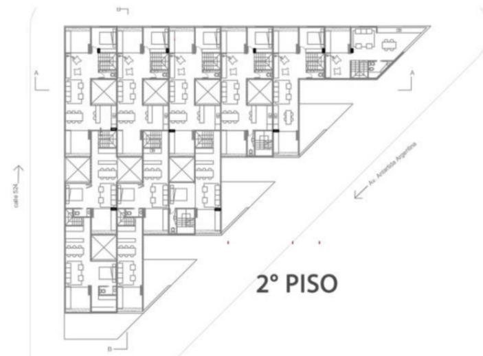
Para el proyecto se prevee un sistema de plenos para el pase de instalaciones de manera que no interfieran con el diseño arquitectónico del conjunto, y por los cuales pasarán las bajadas cloacales, montantes de AF, desagües pluviales, ventilaciones, y demás instalaciones requeridas.
