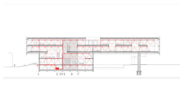
**Referencias:** 1- Boca de impulsión. 2- Tanque de reserva incendio. 3- Conexión a red. 4- Equipo presurizador. 5- Hidrante. 6- Rociadores. 7- Detector de humos. 8- Matafuegos.
