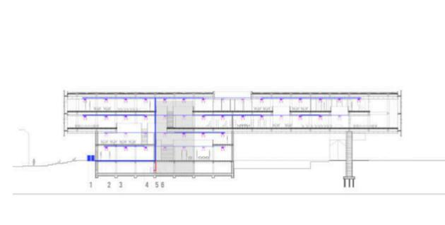
**Referencias:** 1- Unidad exterior. 2- Unidad interior evaporadora tipo cassette. 3- Circuito VRV con recuperación de calor. 4- Roof-top condensado por agua. 5- Conducto de inyección. 6- Conducto de Extracción.
