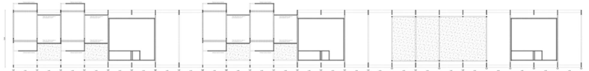
**PLANTA DE ESTRUCTURA +0.60** | Tanto las viviendas como núcleos se encuentran 0.85 m por encima del nivel cero. Se utilizan tanto vigas como muros haciendo las veces de "tapas". La estructura del núcleo de ascensor y escalera tanto en el subsuelo como en los niveles superiores se ejecuta in situ de manera independiente a la estructura prefabricada (Ver Montaje)
