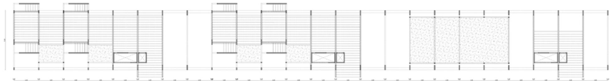
**PLANTA DE ESTRUCTURA +1.00** | Columnas prefabricadas (Ver Catálogo + Montaje); losetas; núcleo de servicios independiente con junta de dilatación prevista en el contacto con la estructura premoldeada, estructura de Steel Framing para los locales y equipamiento.
