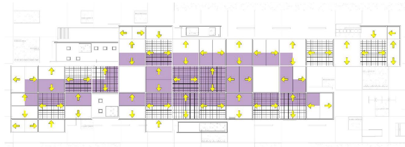
Superficie de cubierta que desagua hacia tanque de recuperación de aguas de lluvia: 3116 m<sup>2</sup>.
