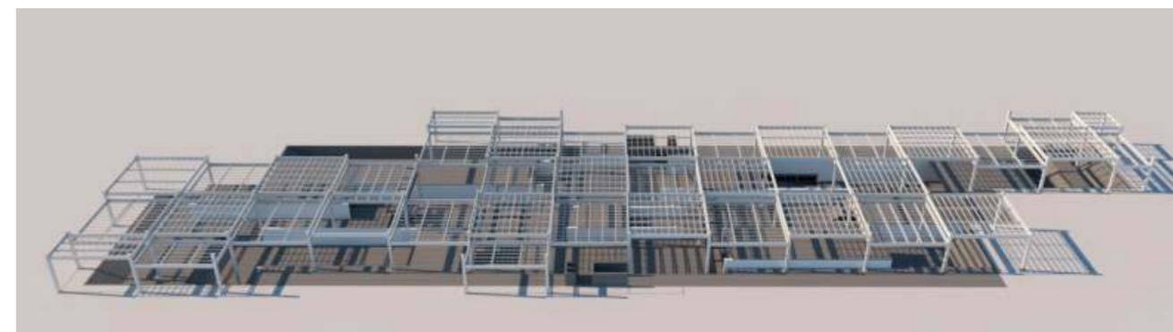
Se encofra y rellena el primer nivel de losas de hormigón armado alivianadas postesadas, con espesores que varían entre los 20 y 25 cm de espesor según corresponda. La elección de estas losas se hace a partir de cuestiones funcionales y de lenguaje del proyecto. Se colocan las vigas metálicas doble T que sostendrán los puentes transversales.
