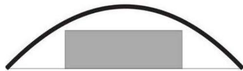
El proyecto recoge la idea de mantener su preexistencia perimetral de tal manera de dejar caer en la misma una nueva capa tecnológica y con ella los nuevos programas de un nuevo uso. Se monta como un caparazón de metal de estructura independiente capaz de mantener temperaturas adecuadas para el interior sin afectar a los muros históricos. El objetivo principal lograr nuevas alturas para así contemplar el programa requerido.
