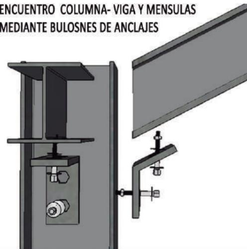
ENSAMBLE DE DINTEL SUPERIOR DE PÓRICO MEDIANTE PLANCHUELAS Y BULONES DE ANCLAJE IN SITU, UTILIZANDO MAQUINARIAS Y MANO DE OBRA ESPECIALIZADA PARA SU COLOCACIÓN.
