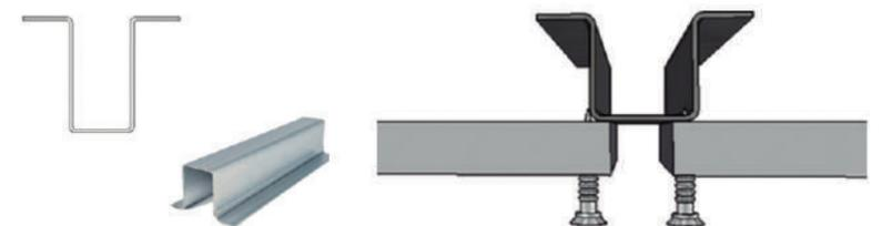
EL PUENTE QUE CONECTA LAS PREEXISTENCIAS CON EL PROYECTO DE INTERVENCIÓN ESTÁ COMPUESTO POR PERFILES METÁLICOS COMO ESTRUCTURA PORTANTE Y PANELES DE VIDRIO COMO CERRAMIENTO, CONFORMANDO LA PIEZA A TRAVÉS DEL ENSAMBLE DE LAS PARTES.
