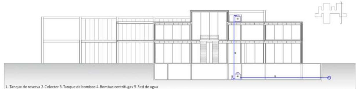
1- Tanque de reserva 2-Colector 3-Tanque de bombeo 4-Bombas centrífugas 5-Red de agua
