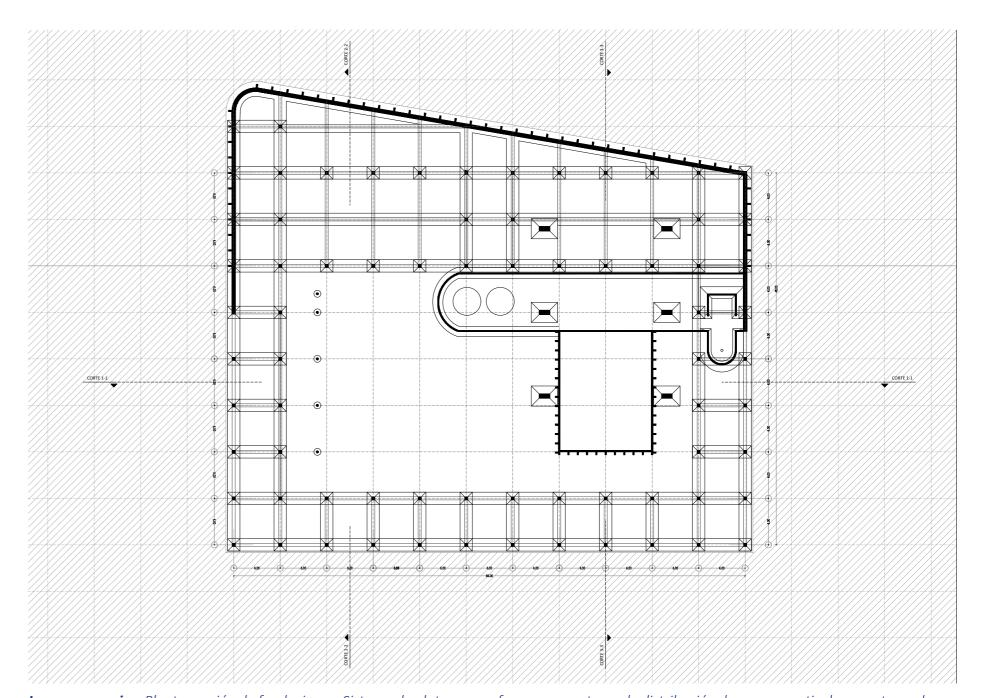
**Imagen superior:** Planta sección de fundaciones. Sistema de platea con refuerzos en sectores de distribución de cargas particulares: este es el caso de la fundación de ambas torres a los laterales de las cajas, las patas de los pórticos y toda lo que es la espalda del proyecto, es decir, el muro de contención del espacio de los talleres. **Imagen inferior:** Detalle de piezas premoldeadas de hormigón.
