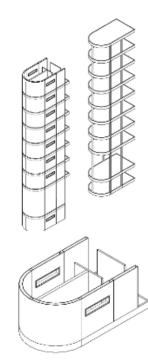
Las **torres** de sanitarios y circulación vertical que se adosan a los laterales de la caja de aulas, se resuelven estructuralmente de manera independiente
