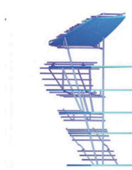
Estructura de tubos principales y secundarios
