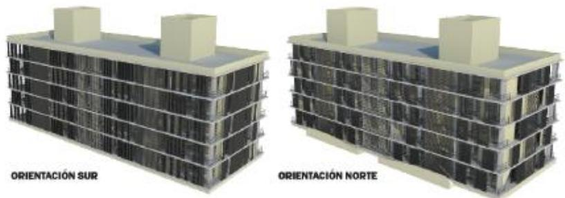
Se podría decir entonces, que las grandes ventajas de este sistema, son la disminución de ganancias solares, el filtrado de vientos, la separación entre exterior e interior y la transformación de la luz directa en un ambiente luminoso.
