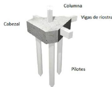
En este caso, se decidió la utilización de cabezales con tres pilotes, unidos mediante vigas de arriostramiento.
