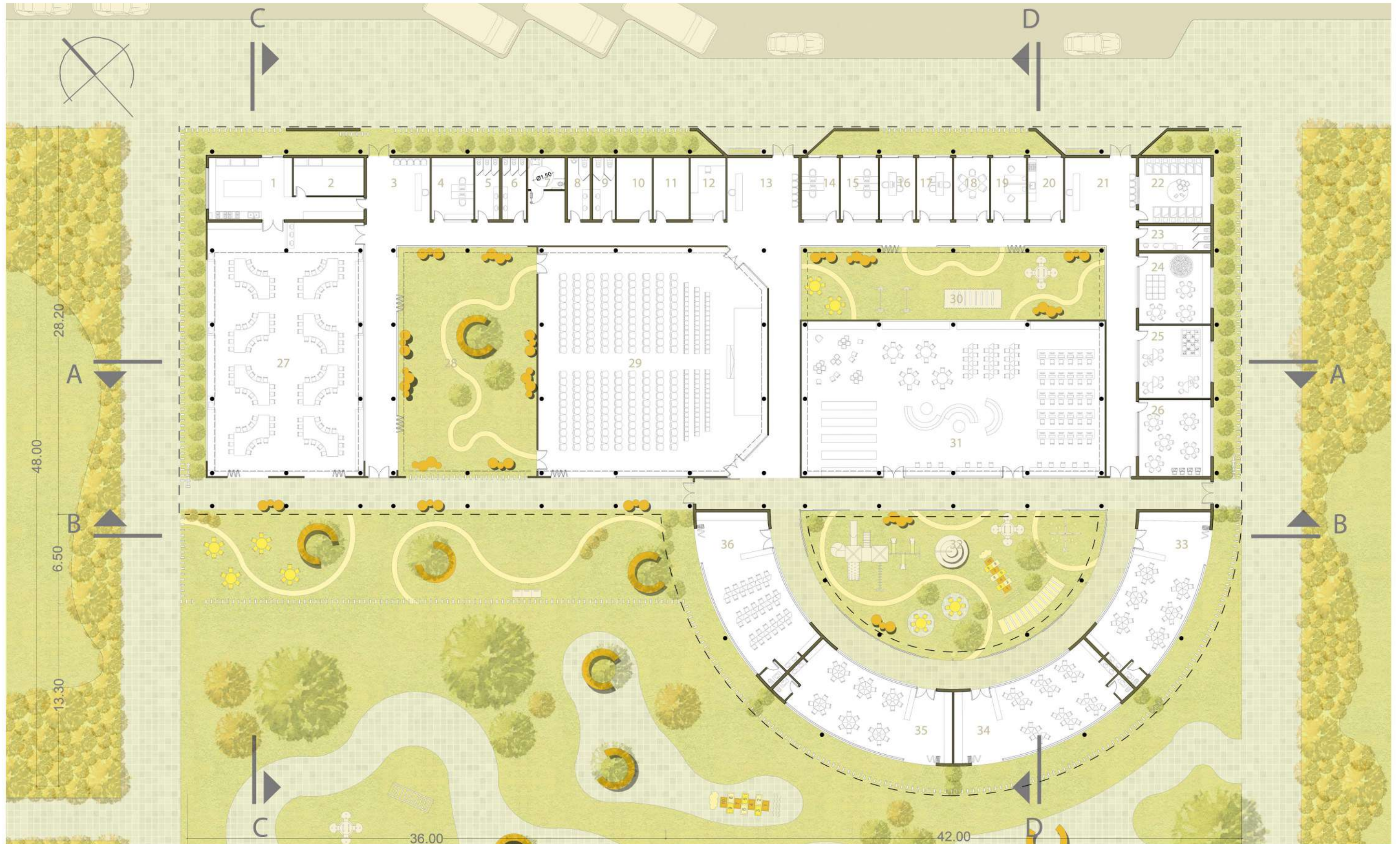
1. Cocina 2. Depósito 3. Hall de acceso proveedores 4. Fundación 5. Baño niños 6. Baños niñas 7. Baño discapacitados 8. Baño hombres 9. Baño mujeres 10. Guardado material didáctico 11. Guardado de elementos de Ed física y Música 12. Maestranza 13. Hall de acceso jardín 14. Preseptoria jardín 15. Preseptoria maternal 16. Dirección jardín 17. Dirección maternal 18. Equipo de orientación escolar 19. Consultorio médico 20. Office 21. Hall de acceso maternal 22. Sala lactantes 23. Servicio maternal y sala de cambiado 24. Sala deambuladores 25. Sala 2 años 26. Comedor maternal 27. Comedor 28. Patio del salón de actos 29. Salón de actos 30. Patio maternal 31. Sala de informática y biblioteca 32. Patio del jardín 33. Sala 3 años 34. Sala 4 años 35. Sala multiedad 36. Sala 5 años
