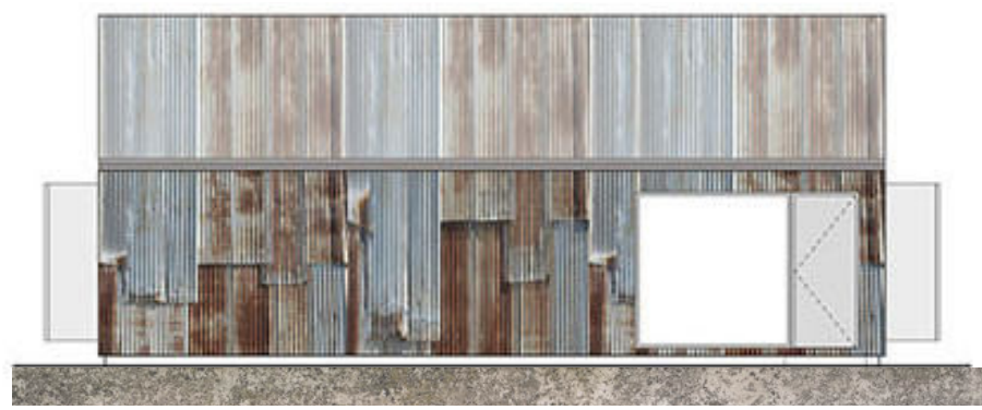
Cubierta y envolvente de chapa acanalada
