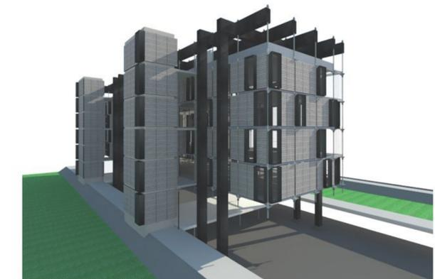
Para la resolución de la cubierta opté por la realización de una cubierta plana húmeda con perfiles y chapa como encofrado perdido. Pese a que la terminación de la cubierta se realiza en obra, considero que ésta es la mejor elección porque las pendientes requeridas para el escurrimiento de las aguas son prolongadas y deben ser contínuas entre panel y panel. En consecuencia se traerá a obra la estructura rigidizada por la chapa sinusoidal que posteriormente actuará como encofrado perdido.
