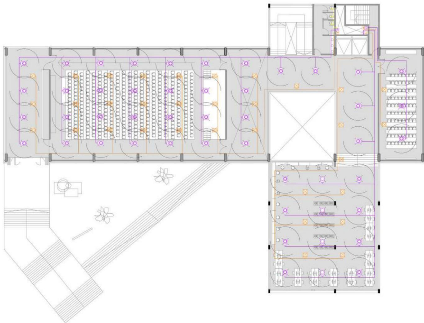
INSTALACIÓN ACONDICIONAMIENTO PLANTA NIVEL AUDITORIO. Esc. 1.300
