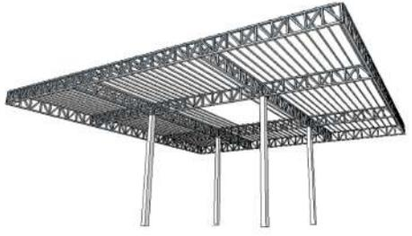
LA ESTRUCTURA PRINCIPAL DE LA CUBIERTA ESTA CONFORMADA POR UNA SERIE DE RETICULADOS DE VIGAS QUE SE ENCUENTRAN APOYADAS SOBRE COLUMNAS DE HORMIGON ARMADO.
