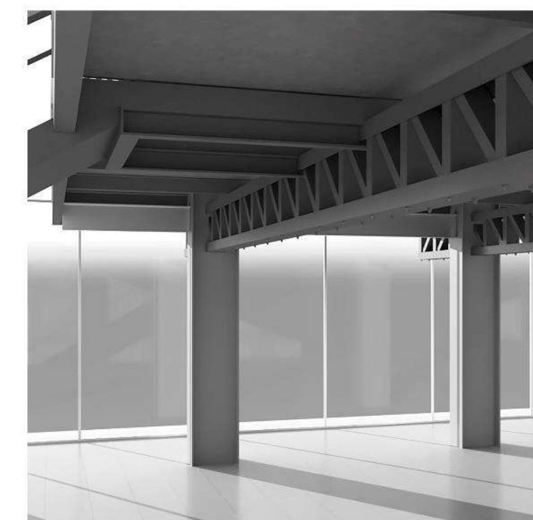
Unión entré vigas y perfiles
