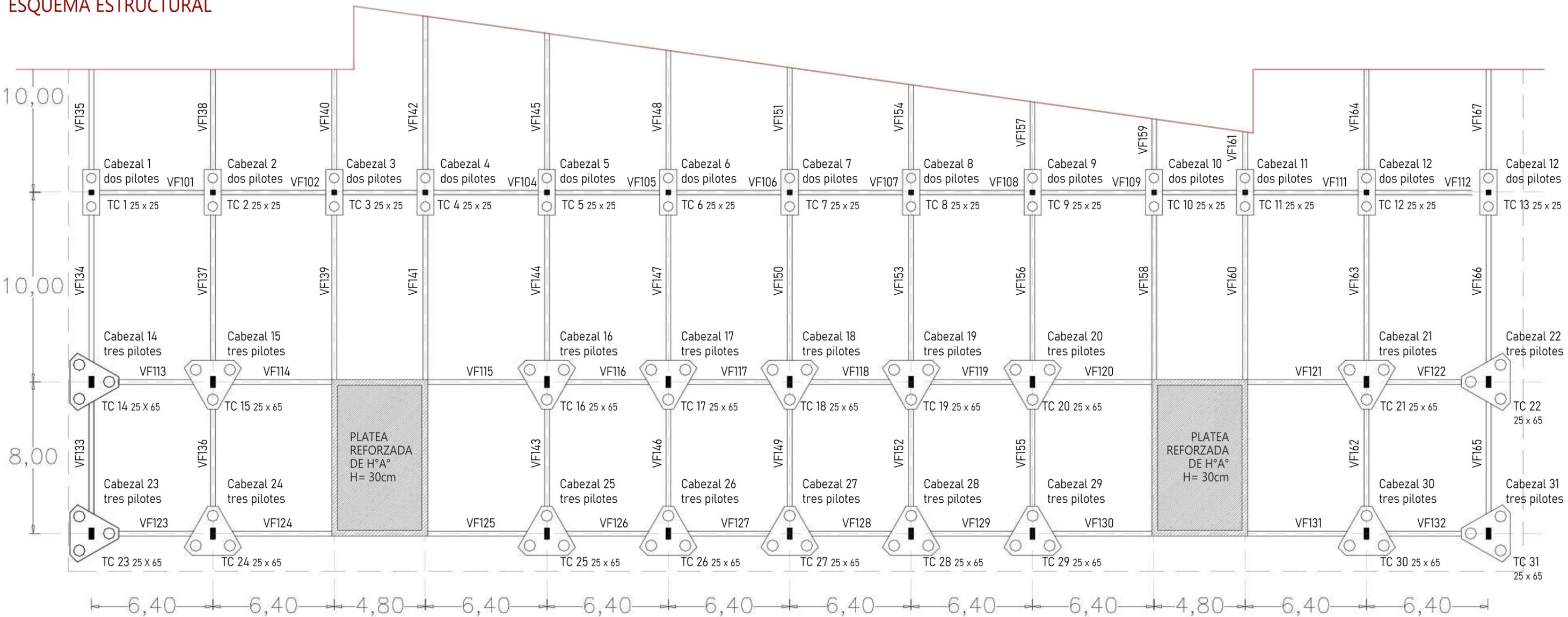
Por ser una zona propensa a inundaciones debido a la cercanía con el río, contamos con un suelo de muy baja resistencia para fundar nuestro edificio. Es por esto que para columnas de hormigón armado de 0,20m x 0,60m, se optó por la utilización de cabezal de 1,25 m de alto, con 3 (tres) pilotes de 0,60m diámetro, ya que reciben la mayor carga del edificio (PB + 9 niveles).
