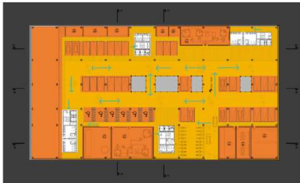
PLANTA SUBSUELO MEDIOS DE ESCAPE
