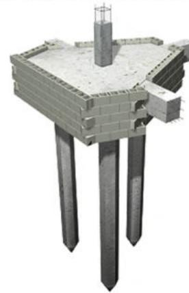
CABEZAL DE 3 PILOTINES
