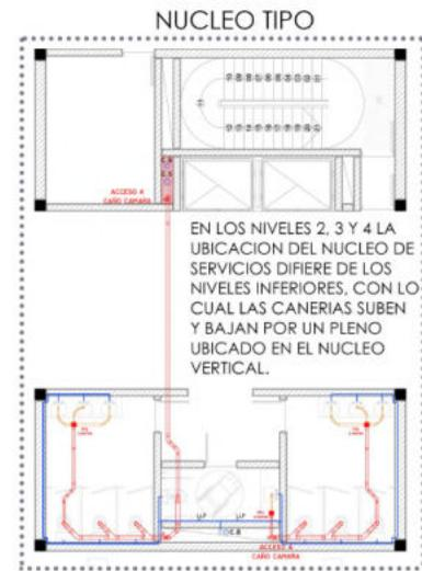
EN LOS NIVELES 2, 3 Y 4 LA UBICACION DEL NUCLEO DE SERVICIOS DIFIERE DE LOS NIVELES INFERIORES, CON LO CUAL LAS CANERIAS SUBEN Y BAJAN POR UN PLENO UBICADO EN EL NUCLEO VERTICAL.
