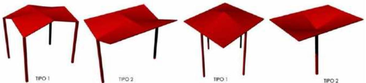
La cubierta del proyecto tiene la forma fundamental simétrica del paraboloides hiperbólico
