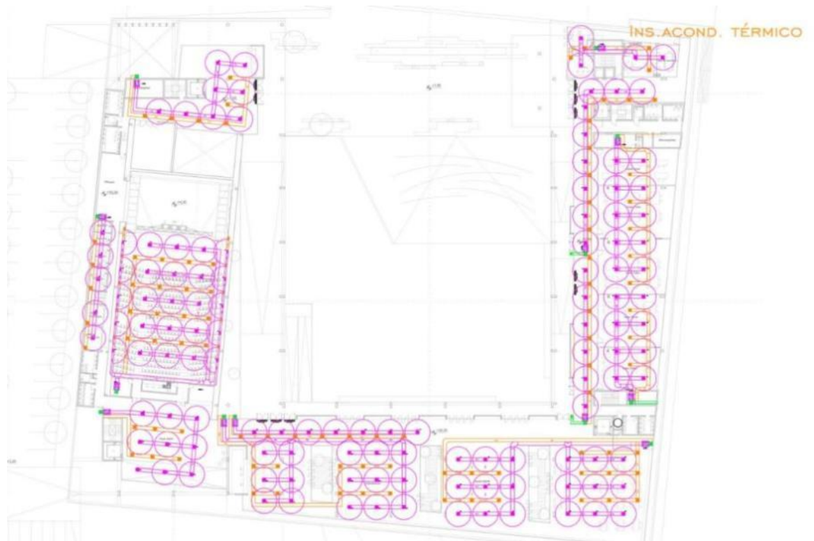
Aire acondicionado, zonales divididos condensados por aire, inversión de ciclo. Planta Alta
