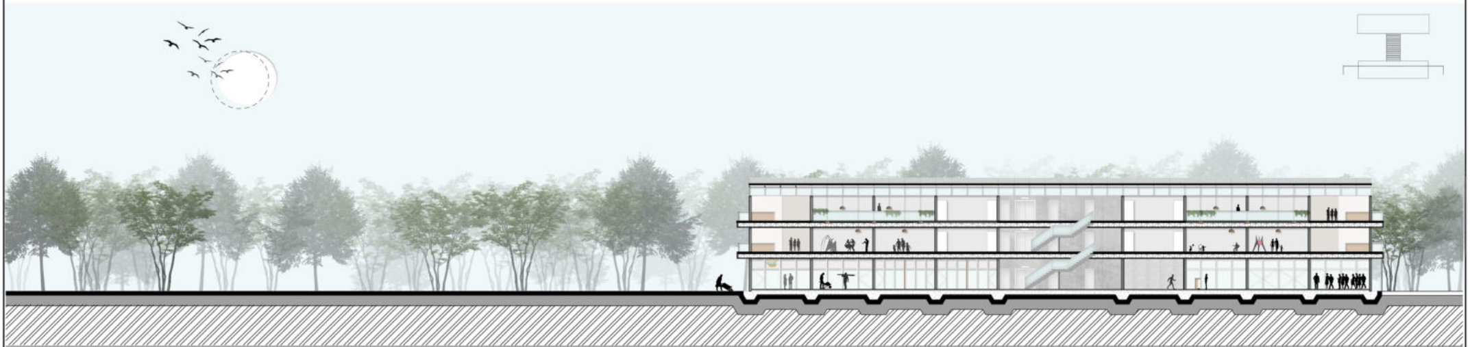
CORTE LONGITUDINAL NAVE DE HABITAR / Esc. 1:350
