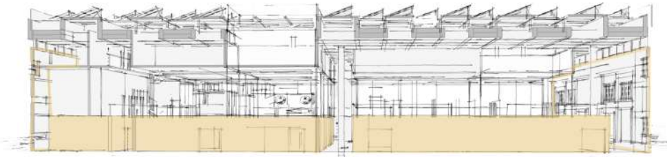
Fachadas y piletos pre-existentes
