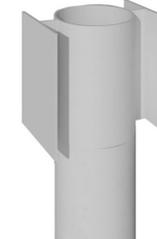
Otro elemento metálico, conforma el vínculo entre columna y columna. Se introduce dentro de las mismas y queda reforzado por el colado de hormigon dentro de las columnas.
