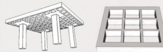
emparrillado de HA
