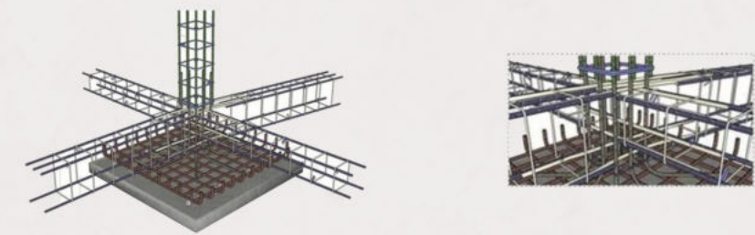
vinculación entre armaduras de cada elemento
