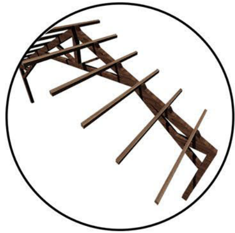
CABRIADAS DE MADERA ORIGINALES
