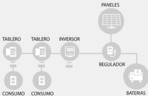
AL IGUAL QUE EN EL SISTEMA DE RECOLECCIÓN DE AGUA PLUVIAL, **ESTE CUENTA CON LA CONEXIÓN AL SISTEMA TRADICIONAL ELÉCTRICO** PREVIENDO LA FALTA DE ACUMULACIÓN DE ENERGÍA PARA LA ALIMENTACIÓN DE LOS SISTEMAS ELÉCTRICOS O DE AGUA CALIENTE POR CALDERAS ELÉCTRICAS CON EL OBJETIVO DE MAXIMIZAR LOS USOS Y CONSUMOS EN LA APLICACIÓN DE LOS SISTEMAS TRADICIONALES.
