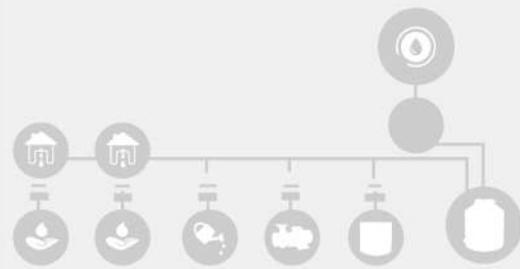
ESTE SISTEMA GESTIONA LA ALTERNANCIA DE LA UTILIZACIÓN DE AGUA DE LA RESERVA Y LA RED GENERAL. ESTO QUIERE DECIR QUE CUANDO EL AGUA DE LLUVIA SE ACABA PASA AUTOMÁTICAMENTE A SUMINISTRAR LA DE RED Y SI HAY PRECIPITACIONES DE NUEVO, SE VUELVE A UTILIZAR LA DEL DEPÓSITO
