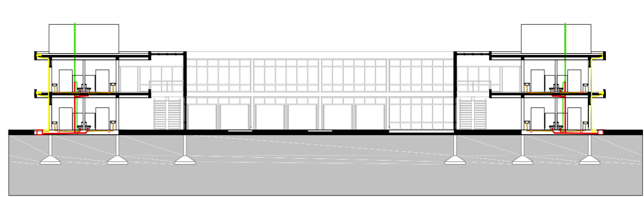
Corte transversal desagües cloacales y pluviales
