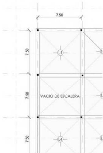
El sistema de losas de Steel Deck es un sistema de losa colaborante, combina láminas de acero galvanizado con concreto. Sirve como encofrado y refuerzo estructural. Elimina el uso de moldes de madera. Acelera la construcción y reduce costos. Se usa en edificios industriales y comerciales.
