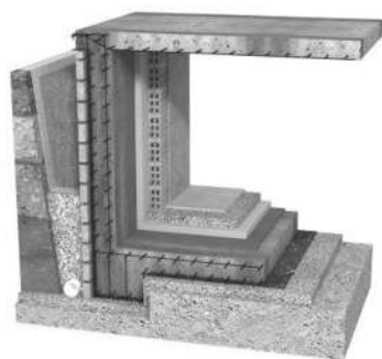
esquema submuración de h°a°
