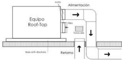
Se ubican termostatos en los locales para comandar y regular las salidas de cada equipo. Un equipo se destina a la climatización de las salas flexibles, un circuito de difusores y retornos cada dos niveles por las dobles alturas. Otro equipo se destina a la climatización de la administración y áreas de coworking, un circuito de difusores y retornos cada dos niveles por las dobles alturas. Los otros dos equipos se destinan a la climatización de aulas y talleres, un circuito por cada nivel.
