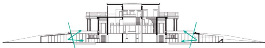
La fachada interior de cada volumen es completamente vidriada para que siempre se pueda observar la preexistencia desde el interior en cualquier punto de la nueva intervención, lo cual se decide darle una inclinación para lograr un mejor ángulo e iluminación natural en los espacios interiores. Se pretende generar un efecto en el que el observador pueda estar en el interior y en el exterior a la vez.
