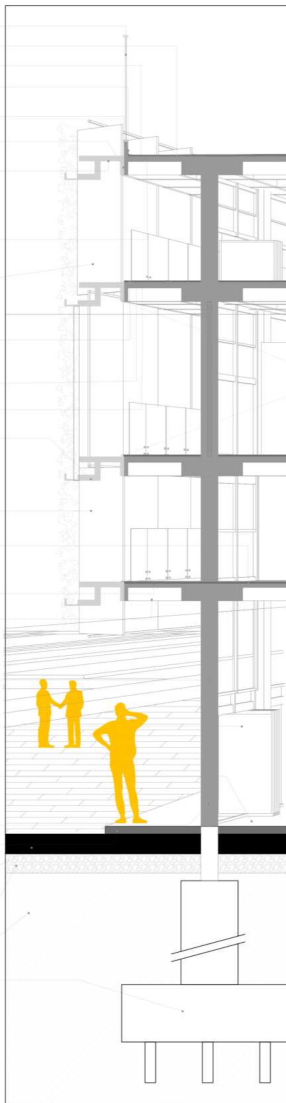
CORTE CONSTRUCTIVO ESC 1:50 LOSA CASETONADA - ESTRUCTURA METALICA
