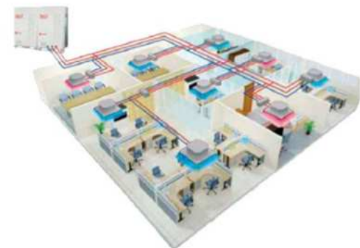
Refrigeración y climatización simultánea
