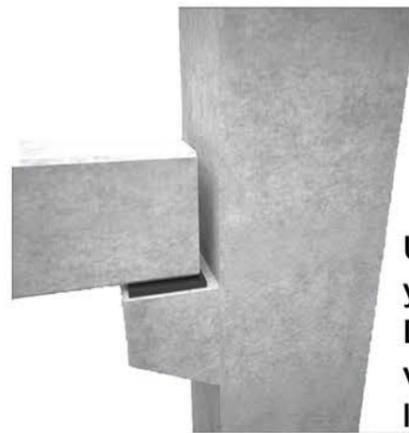
Unión entre columna prefabricada y viga prefabricada. Dicha unión sucede por apoyo de la viga sobre una "pestaña" saliente de la columna.
