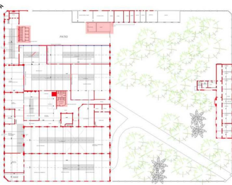
Planta baja: en la propuesta se ve como sacando los baños se mejorar con la circulación y genera mas fluides entre los espacios logrando una mejor conexión de las partes
