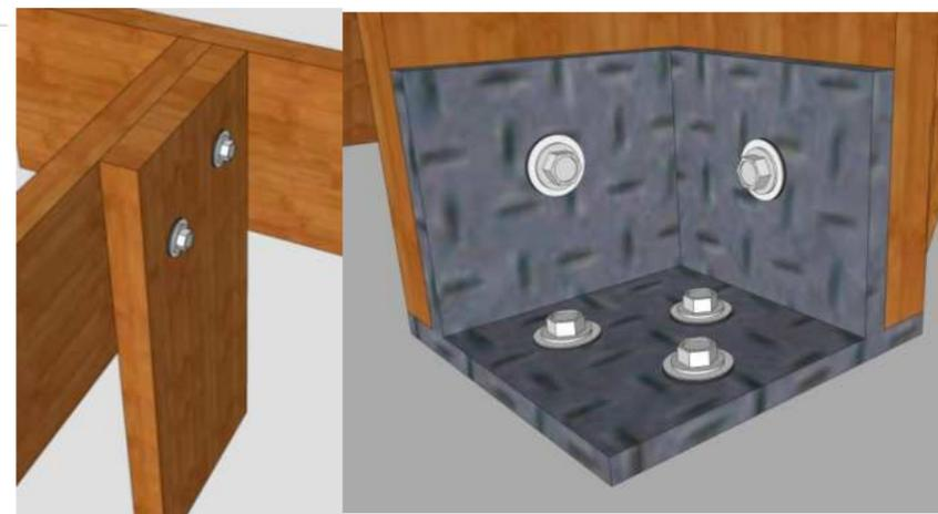
La unión de las piezas se ara de la forma mas practica posible para un fácil armado y montaje en obra
