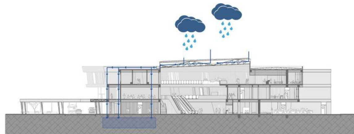
Captación de aguas a través de canaletas, para su reutilización
