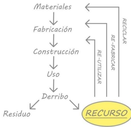
Imagen 28: Etapas en la elaboración de un edificio
