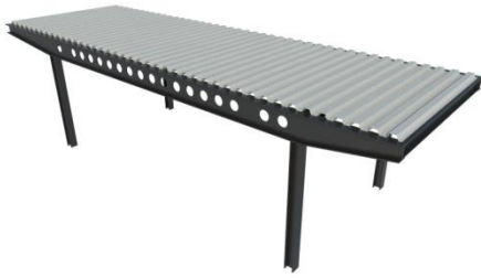
Imagen 38: Placa Colaborante Alcor sobre la estructura metálica
