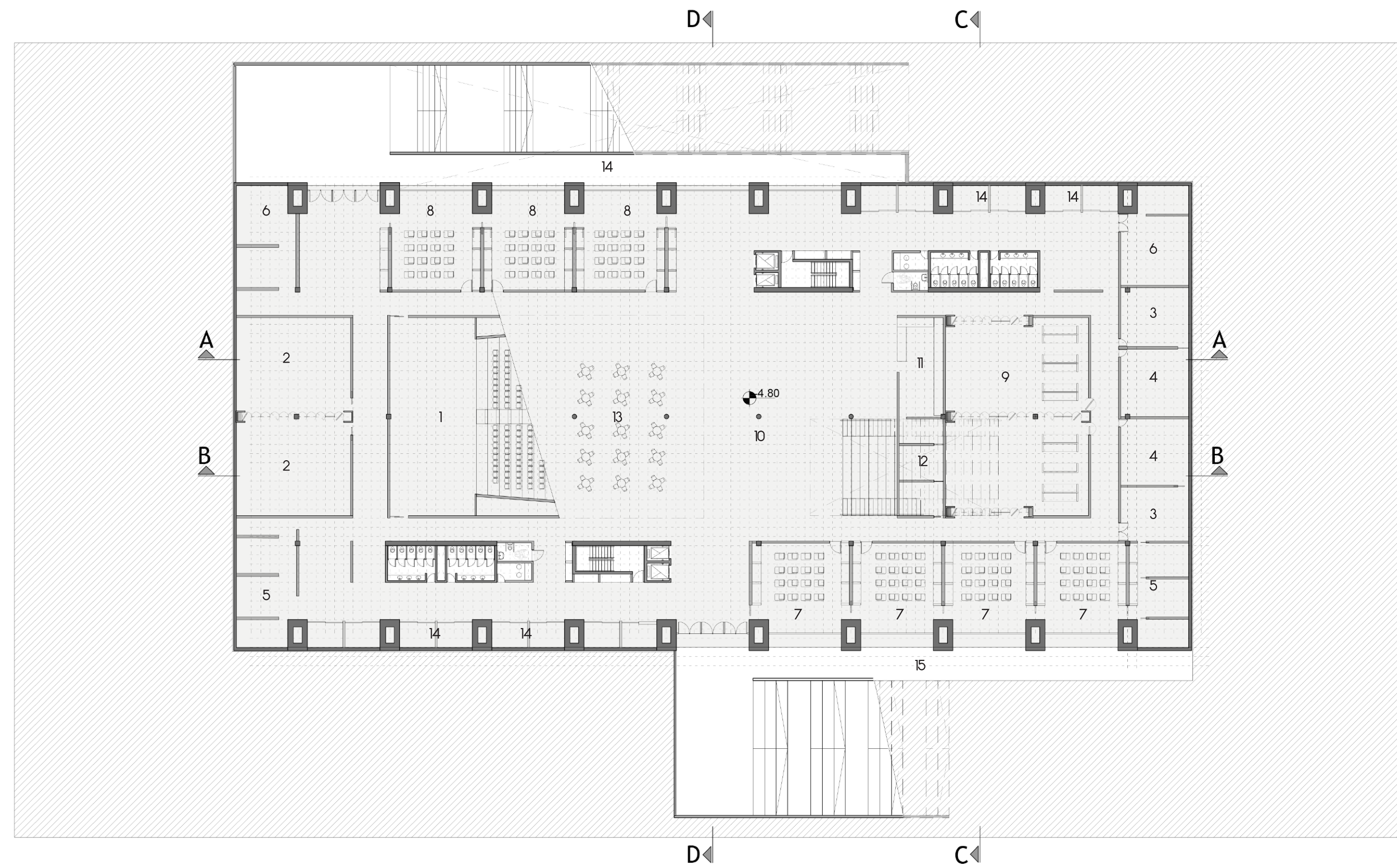
1. Sala espectatulos / 2. Apoyo sala / 3. Guardado / 4. Utleria / 5. vestuarios / 6. Office / 7. Aulas / 8. Talleres 9. Biblioteca / 10. Sala de exposiciones / 11. Cocina / 12. Cocina guardado / 13 Bar / 14. bauleras / 15. Patio interno
