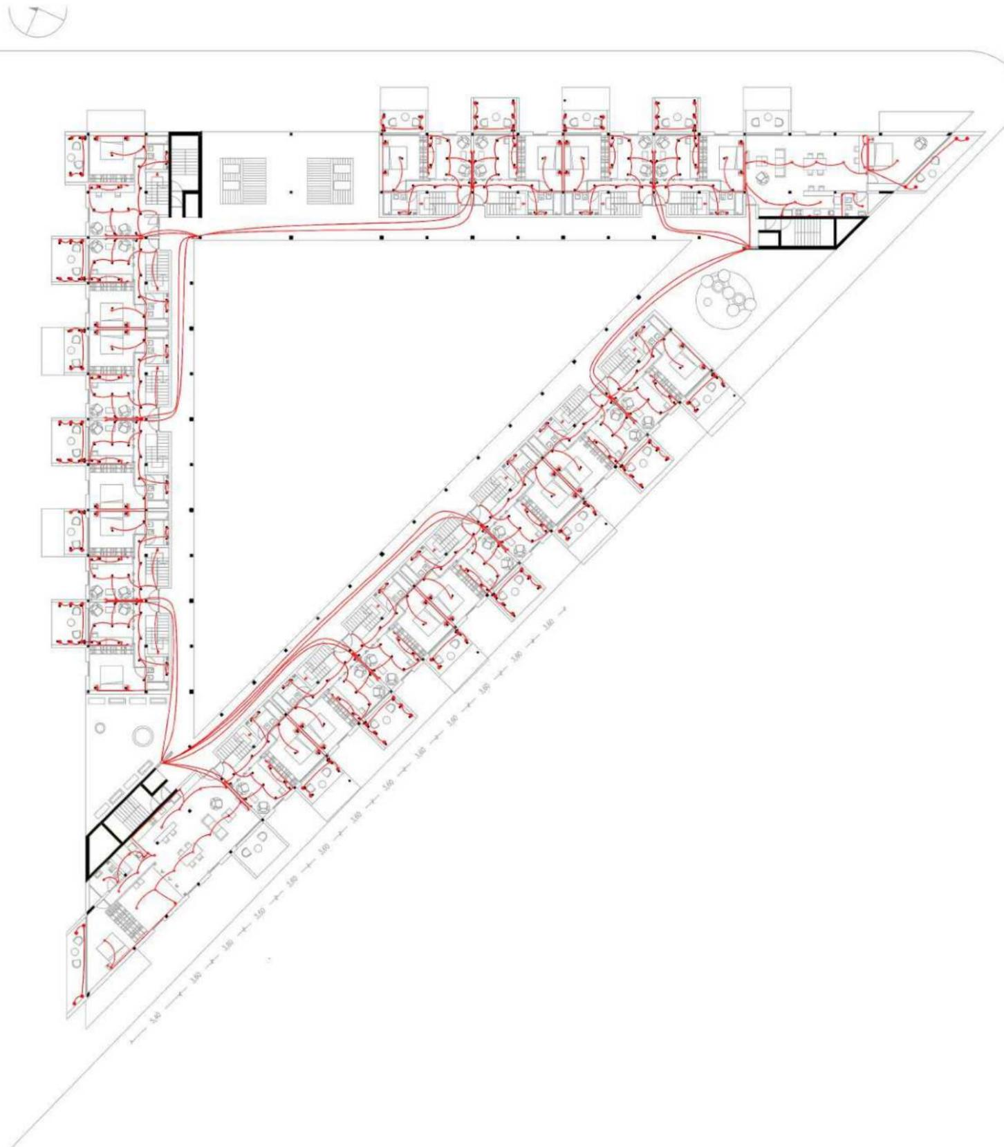
La instalacion electrica del edificio se divide en 3 nucleos de circulacion vertical, que contiene los plenos de instalaciones para repartir el porcentaje 50% para un pleno y 50% para el otro.
