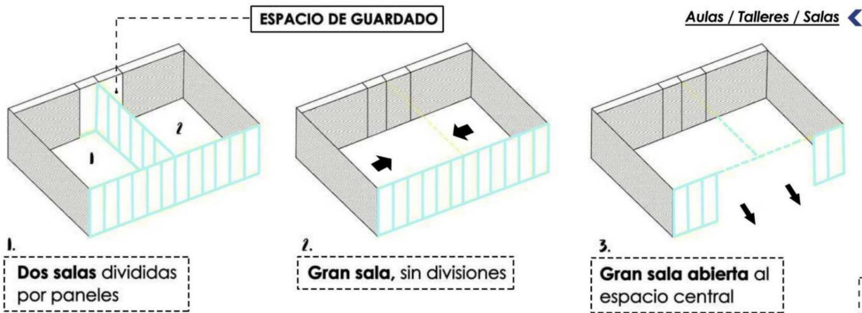
**Sistema Multidireccional:** No requiere guía en el piso, puede girar en ángulos de 90°, trasladarse y almacenarse.
