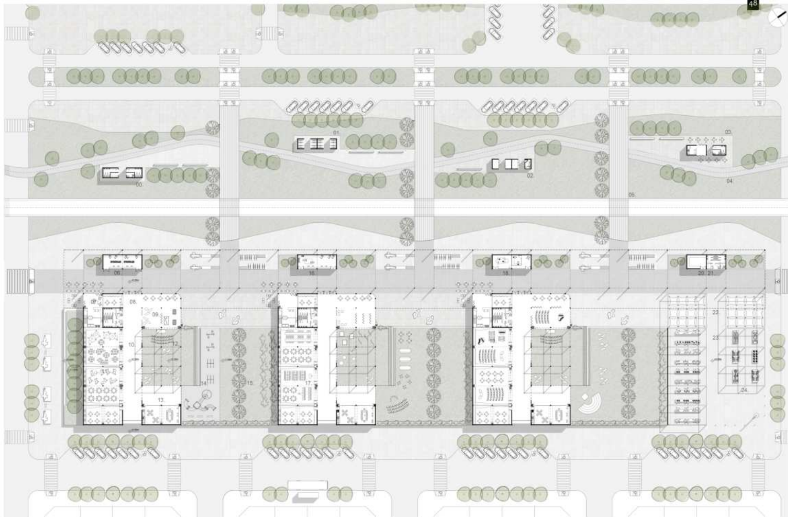
Planta Baja esc 1:600. 00. Sanitarios públicos. 01. Dicietero. 02. Puesto de información. 03. Bar. 04. Sendero caminata y bicicleta. 05. Cruces viales. 06. Librería. 07. Buffet de la escuela. 08. Hall de ingreso con secretaría y sanitarios de alumnos y docentes. 09. Espacio usos múltiples y exposiciones. 10. Circulación semicubierta de la escuela. 11. Aulas taller. 12. Patio con pérgola - exposiciones y conferencias al aire libre-. 13. Sala de docentes y reuniones. 14. Patio de la escuela a +1m. 15. Patio no accesible con vegetación autóctona. 16. Imprenta y gráfica. 17. Aulas taller de escuela Arte con mesadas. 18. Radio pública. 19. Aulas de música con acústica. 20. Depósito de la plaza. 21. Sanitarios públicos. 22. Sector feria artesanos locales fijas. 23. Sector feria artesanos locales temporales. 24. Plaza seca uso libre para el barrio y la ciudad.
