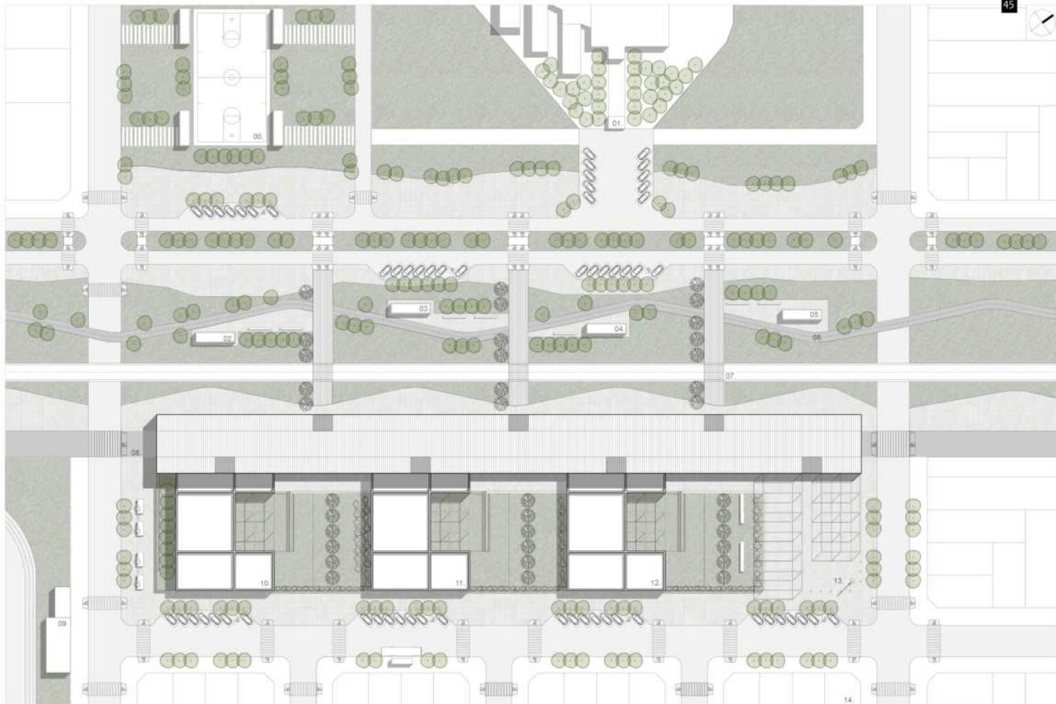
Implantación esc 1:800. 00. Cancha de basquet existente con equipamiento. 01. Asilo de ancianos Inchauppe. 02. Sanitarios públicos. 03. Biciadero. 04. Punto de información. 05. Café. 06. Sendero caminata y bicicleta. 07. Vías de ferrocarril. 08. Calle peatonal atravesando el proyecto. 09. Ingreso al Trote Pehuajo. 10. Escuela Estética N°1. 11. Escuela de Arte Carlos Torralardona. 12. Conservatorio de música Osmar Madema. 13. Plaza seca con predio para feria de artesanos. 14. Barrio Gugteimino.
