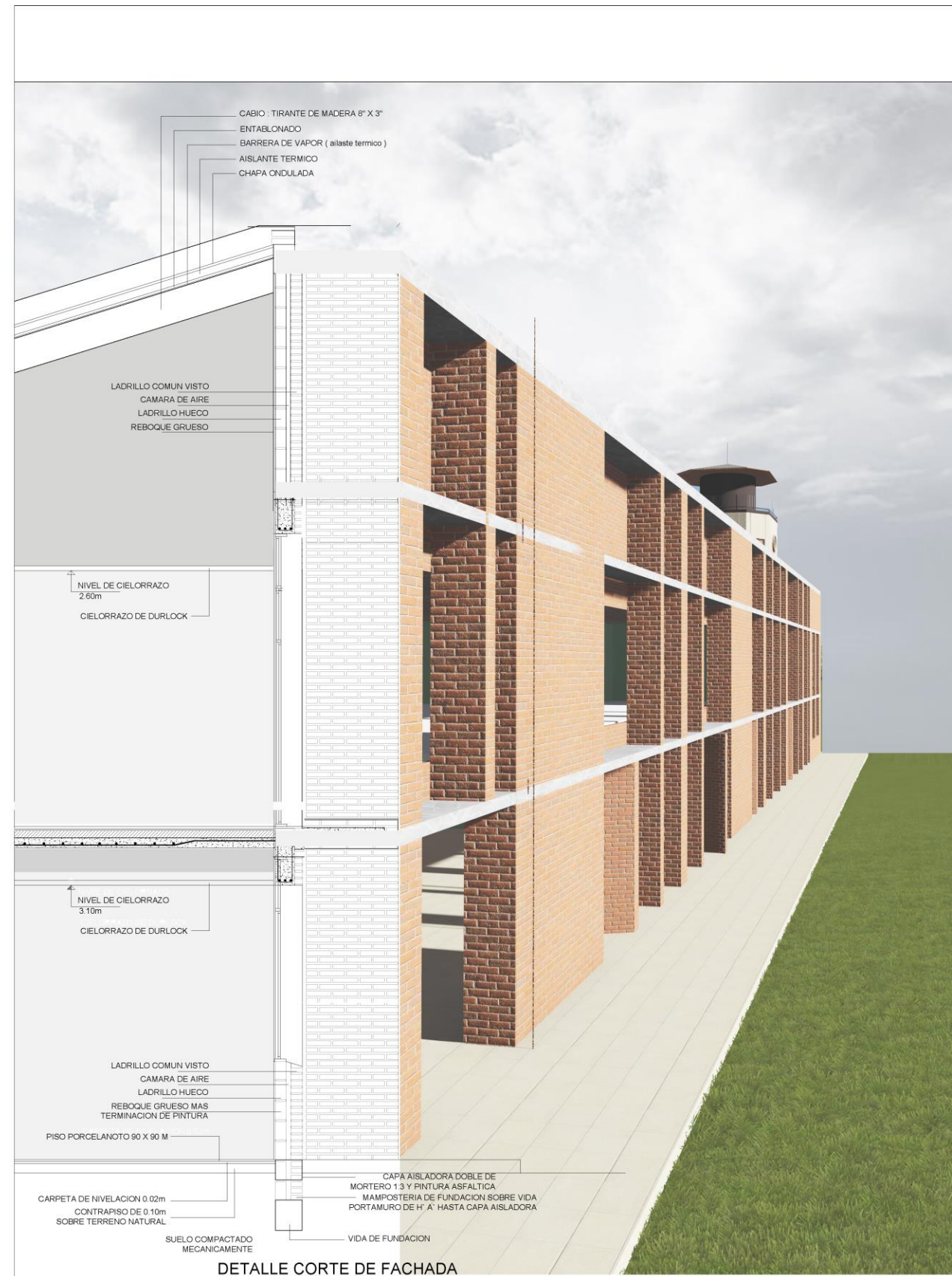
DETALLE DE ENVOLVENTE PARASOLES DE LADRILLO
