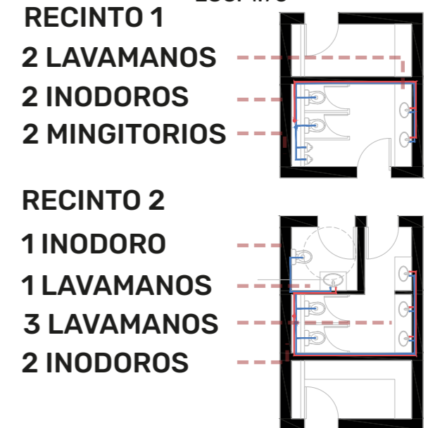
MÓDULO SANITARIO ESC. 1:75
