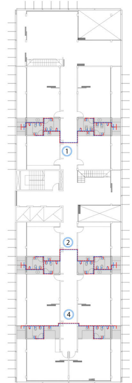
Bajadas de agua fría y caliente para baño, cocina y lavadero de los niveles de residencia familiar.
