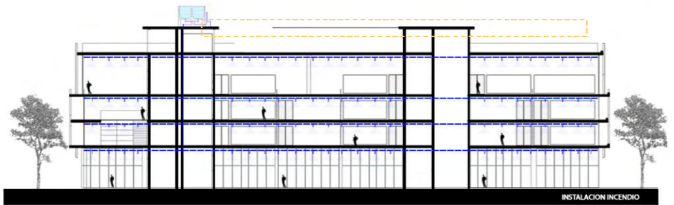
REFERENCIA : PLANO INSTALACIONES SANITARIAS - INCENDIO
