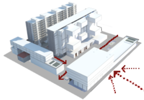
Circulación de acceso al conjunto
