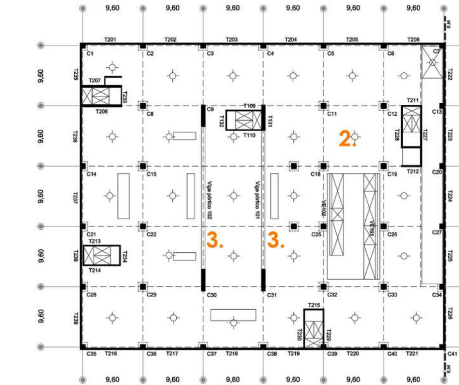
Estructura s/ 1er subsuelo
