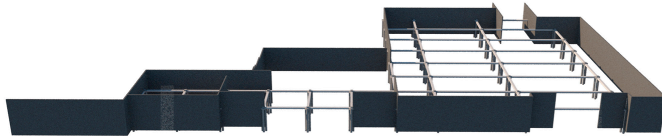
3- ARMADO DE ESTRUCTURA Y LOSA DE H.A. ALIVIANADA CON ENCOFRADO A LA VISTA, ESTRUCTURA DE TRANSICIÓN: H.A. / MADERA
