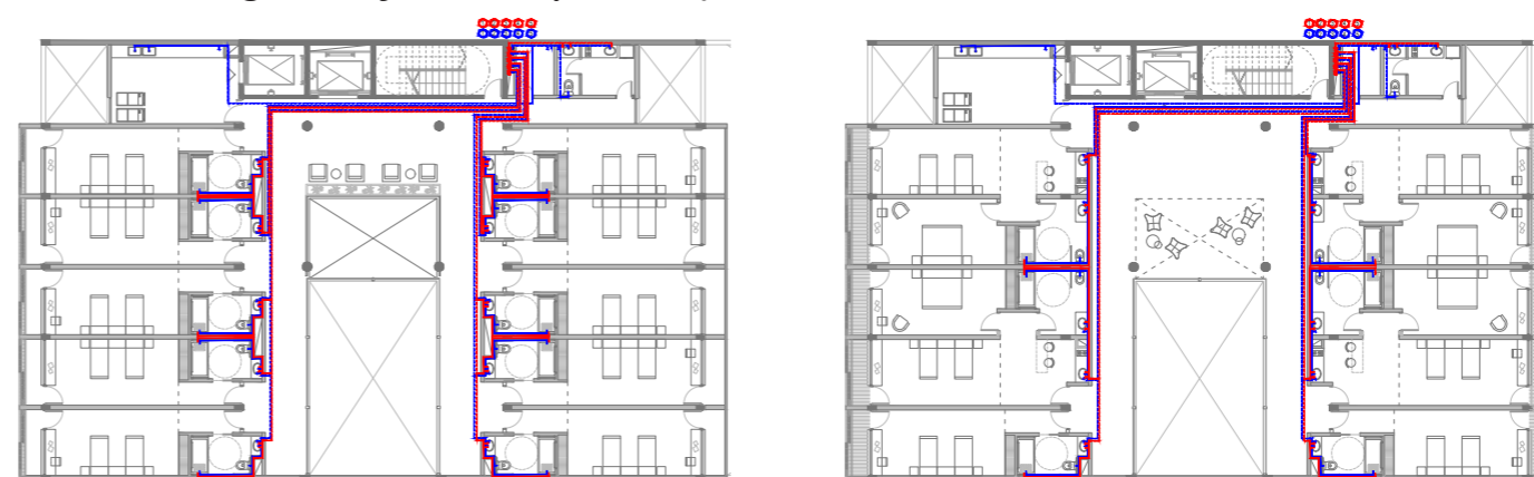
Tendido de agua fría y caliente | Planta tipo
